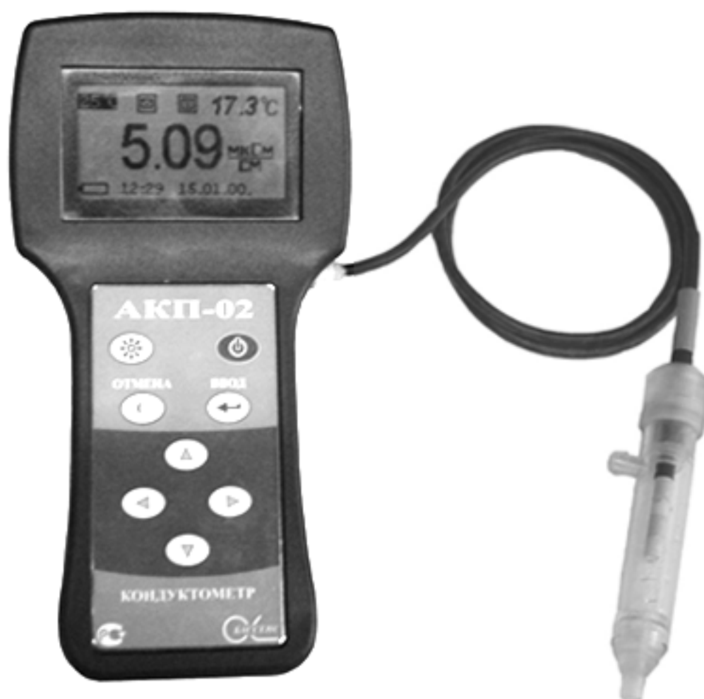
Рис. 1-1 Внешний вид анализатора кондуктометрического АКП – 02
